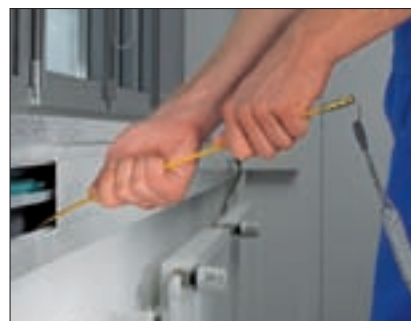
Для быстрого определения местоположения конца штока и его отслеживания применяется компас, ориентирующийся через стены и потолки на супермощный магнит.
